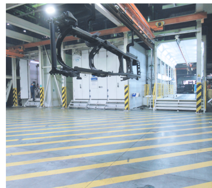
Линия окраски СПК для рам грузовых автомобилей
