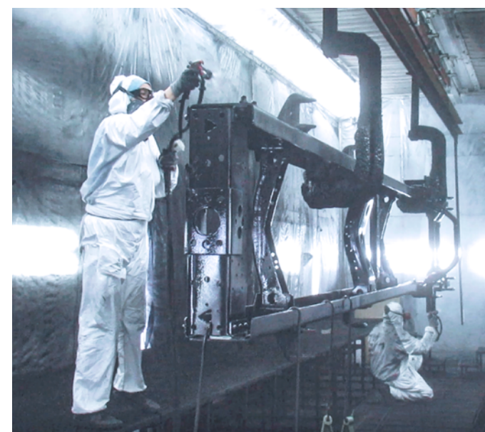
Линия окраски СПК для рам грузовых автомобилей
