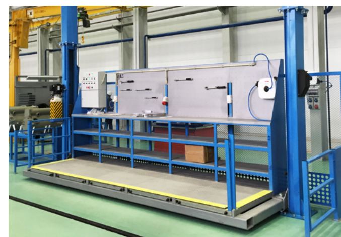
Лифтовая площадка SPK для монтажных работ
