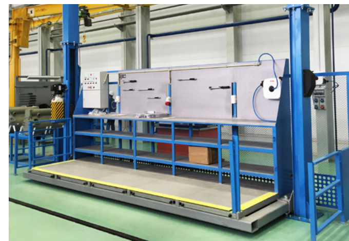
Лифтовая площадка SPK для монтажных работ
