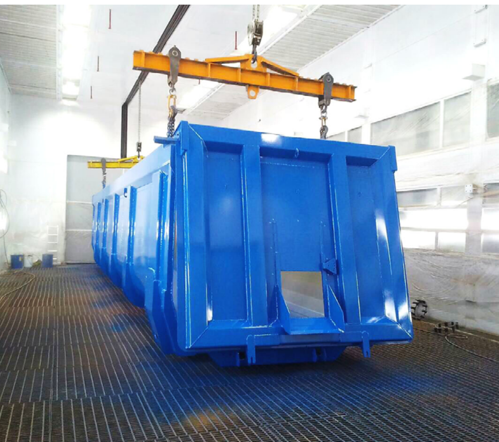
Окрасочная камера SPK-20.8.6 и сушильная камера SPK-18.5.5 для спецтехники «ТОНАР», Московская область
