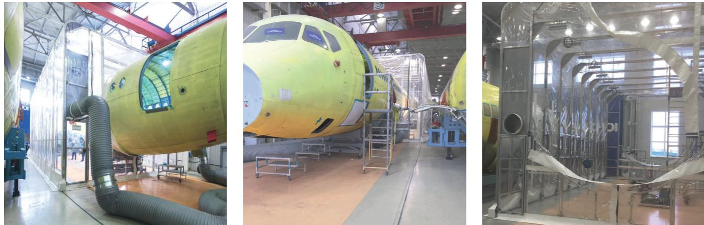
Данную камеру можно перевозить к месту расположения фюзеляжа и окрашивать его в статическом положении
