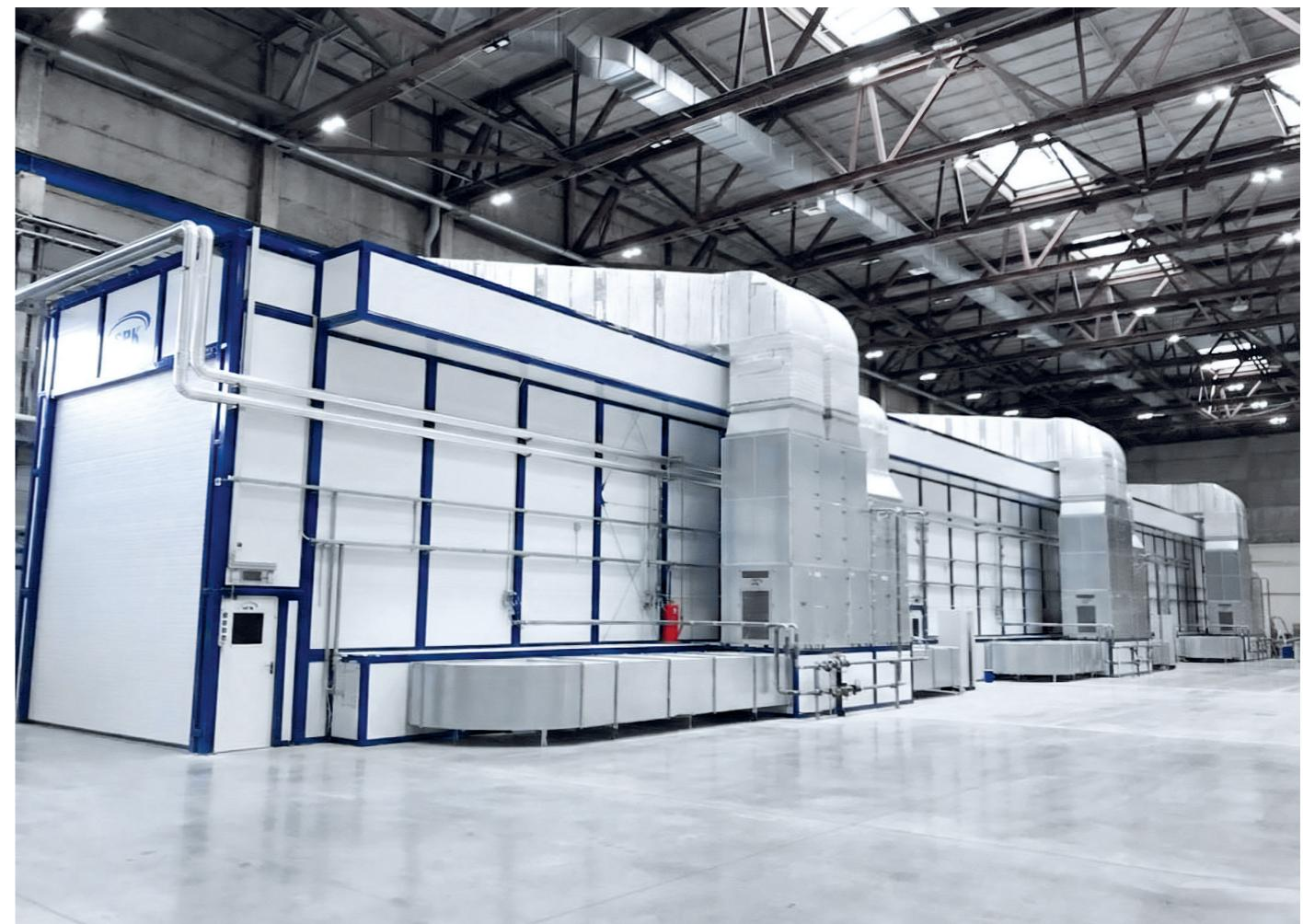
Также особенностью камеры является специальный режим температурной сушки, в ходе которого изделие может находиться в камере при повышенной температуре до 7 суток, с особо высокими требованиями к равномерности температуры и скорости воздушных потоков.
