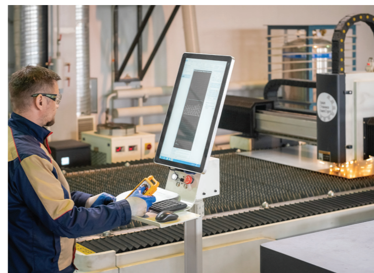
Оптоволоконный станок для лазерной резки металла
