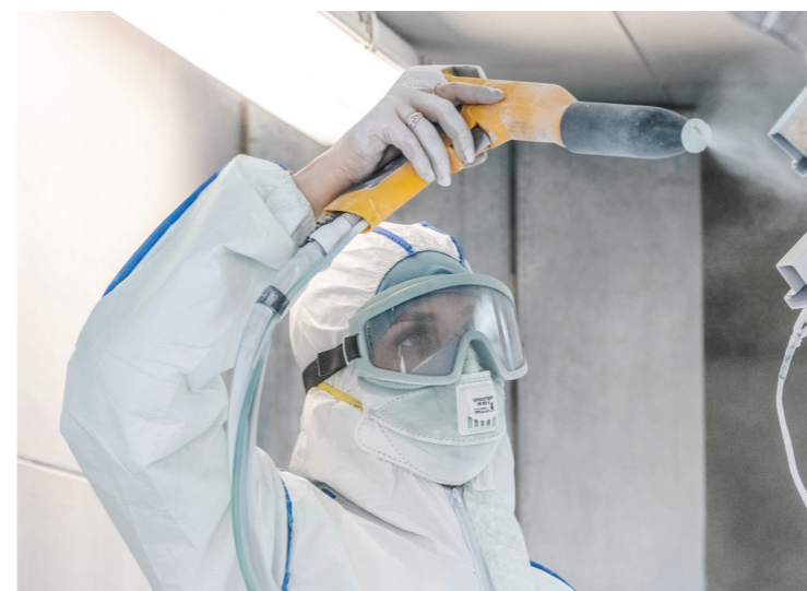
Покрасочная камера с установкой для нанесения порошковых покрытий GEMA
