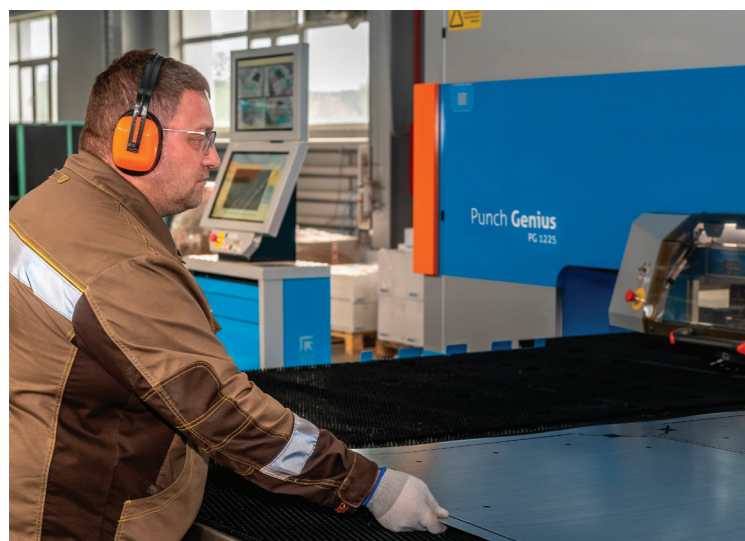
Электромеханический револьверный координатно-пробивной пресс PRIMA POWER
