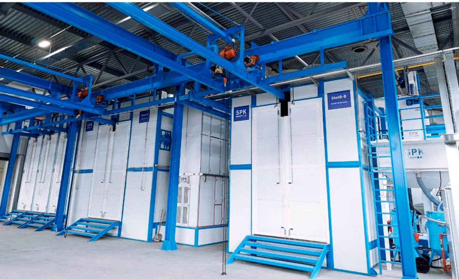
В комплексе установлен плоскопараллельный конвейер, предусмотрено автоматическое смешивание и подача краски, роботизация
